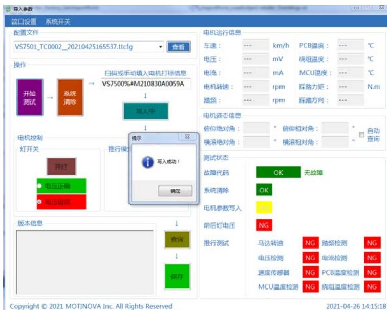
点击“确定”按钮后，测试状态中，电机参数写入状态指示变为 电机参数写入 OK，如果提示“指令操作失败”，需要停止测试，检查线缆或 PCB 是否存在异常；
