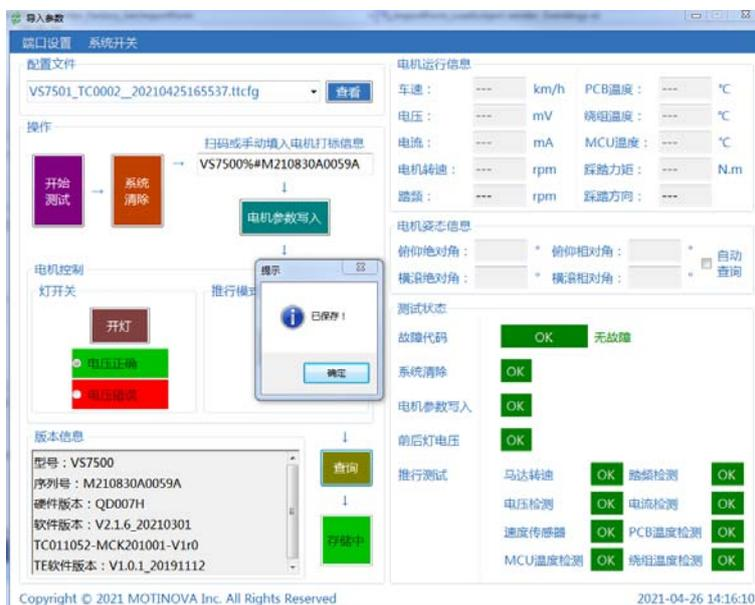
12) 点击“开始测试”按钮, 可进行下一台电机的测试。
