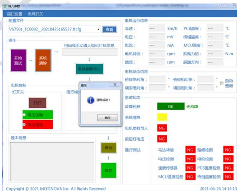
点击“确定”按钮后，测试状态中，系统清除状态指示变为 系统清除 OK，如果提示“指令操作失败”，需要停止测试，检查线缆或 PCB 是否存在异常；
